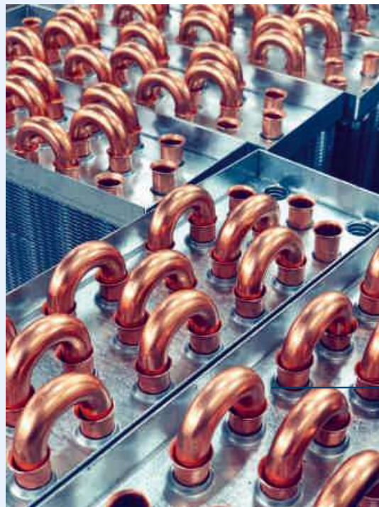
Circuits in fan coils
